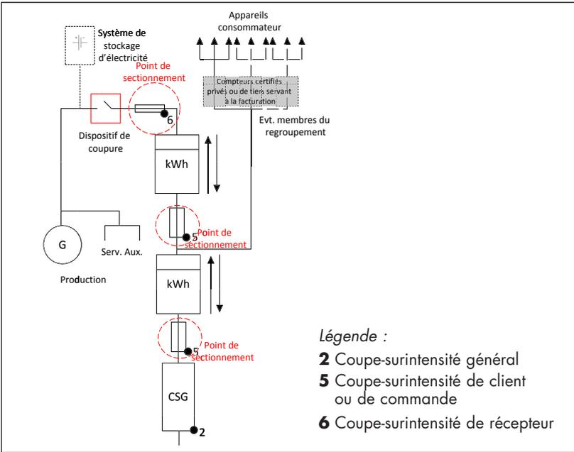
Un dispositif de comptage (TI) indirect est nécessaire si l'intensité traversant le compteur dépasse 80 A.
