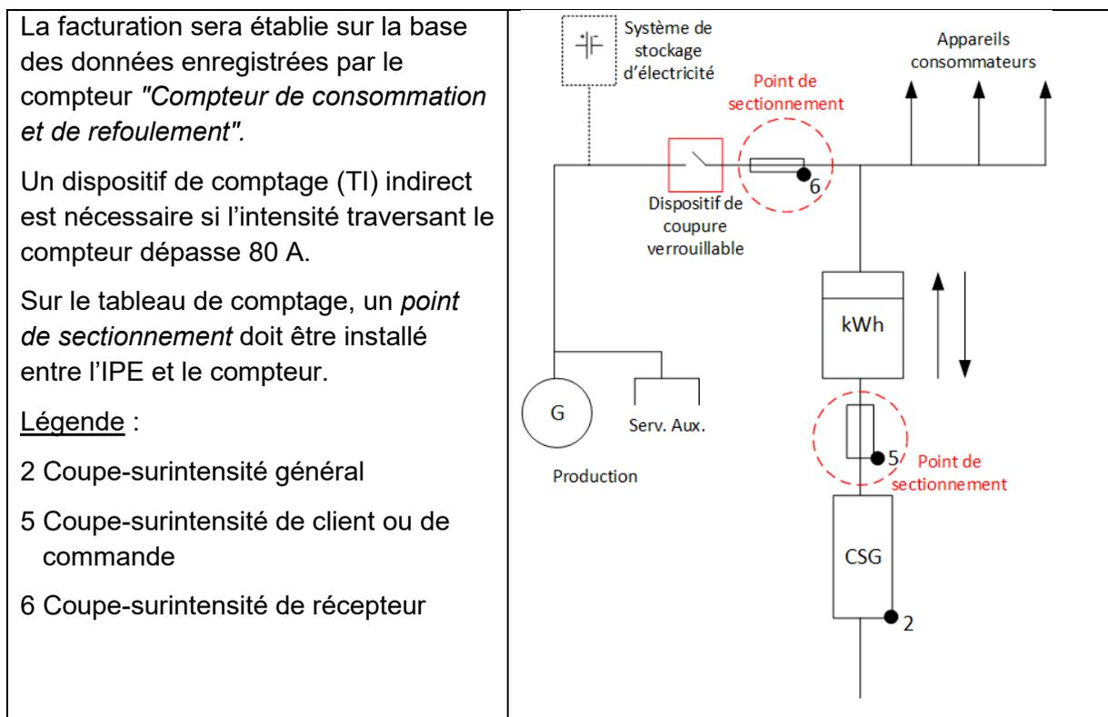
Lorsque le producteur souhaite injecter la totalité de sa production dans le réseau afin de la vendre à un tiers en dehors du site de production, le schéma de comptage de principe est le même que pour les installations >30 kVA. ; la protection RR n'est pas obligatoire pour les IPE <30 kVA.
