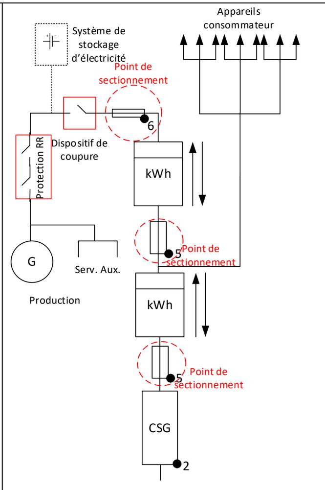
Lorsque le producteur indépendant souhaite consommer sa propre production, aucun bilan n'est effectué ; seul le compteur le plus proche du point de raccordement sert à la facturation.
