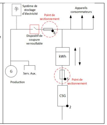
Lorsque le producteur souhaite injecter la totalité de sa production dans le réseau afin de la vendre à un tiers en dehors du site de production, le schéma de comptage de principe est le même que pour les installations >30 kVA. ; la protection RR n'est pas obligatoire pour les IPE <30 kVA.
