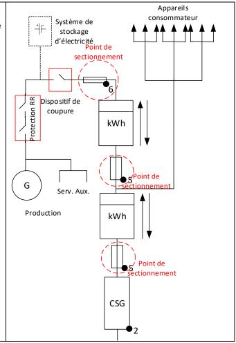
Lorsque le producteur indépendant souhaite consommer sa propre production, aucun bilan n'est effectué; seul le compteur le plus proche du point de raccordement sert à la facturation.
