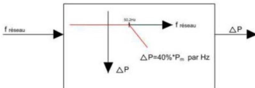
$$\Delta P = 20P_m \frac{50,2 \text{ Hz} - f_{\text{réseau}}}{50 \text{ Hz}} \text{ avec } 50,2 \text{ Hz} < f_{\text{réseau}} < 51,5 \text{ Hz}$$
